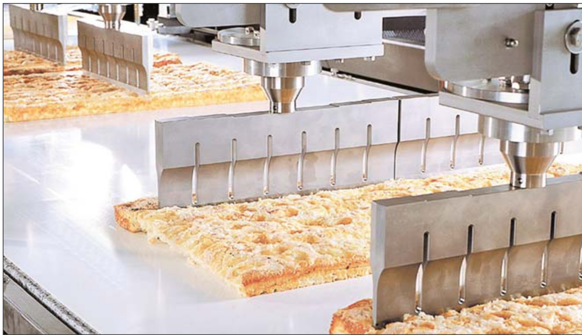
Schneiden mit Ultraschall ist eine Spezialität von Herrmann Ultraschalltechnik aus Ittersbach. Hier werden Kuchenstücke portioniert. Firmengründer Walter Herrmann, Geschäftsführer Arnold Schneider und Projektmanager Volker Aust (von links) an einer Versuchsanlage, deren Entwicklung vom Bundeswirtschaftsministerium gefördert wird. Fotos: privat
